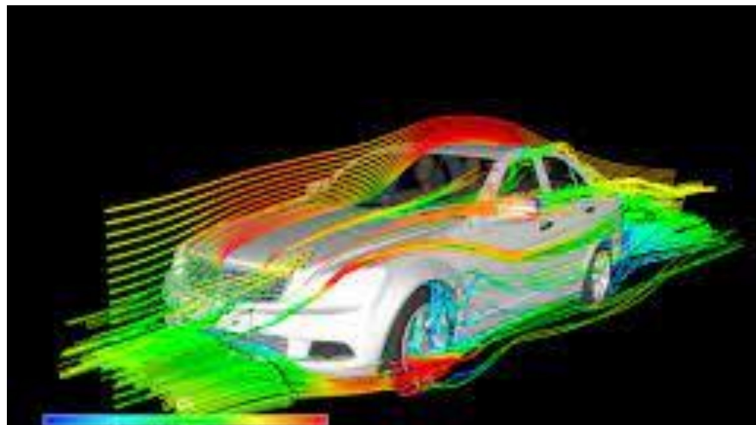
1-rasm. Avtomobilning aerodinamik xususiyatlarini virtual sinov orqali aniqlash
